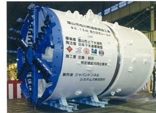
シールド機と呼ばれるトンネルを掘る機械
