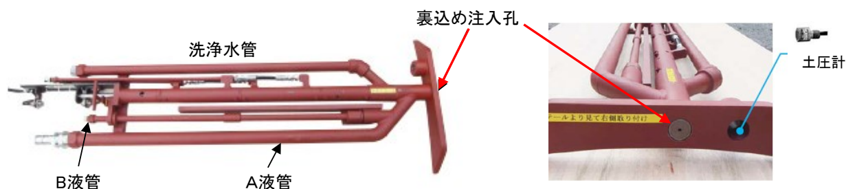
シールド機に取付けた同時裏込め注入装置(第 3.5 世代)
