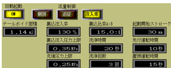
シールド機オペレーターによる同時裏込め注入と操作パネル
