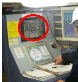
シールド機オペレーターによる同時裏込め注入と操作パネル
