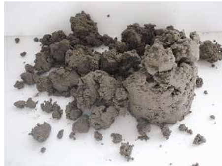
非エア系配合解凍後 崩壊
