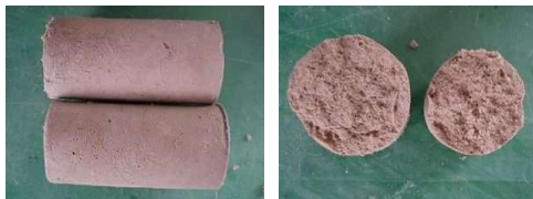
解凍後供試体(エア系) 供試体損傷なし
