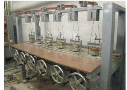
圧密試験装置(φ60mm×H20mm)
