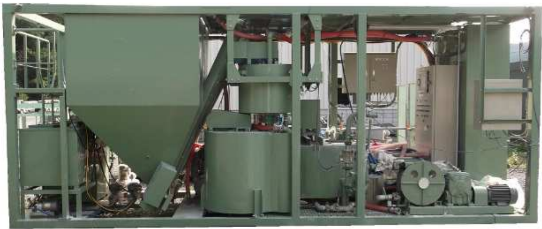
型式CSH-01 (寸法 L6.5m × W2.1m × H2.7m、電気容量 AC200V/25kW、空重量 5.3ton)
