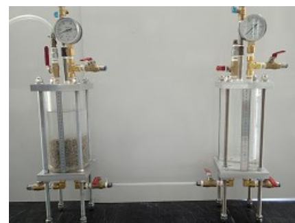
透水試験実施状況
