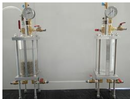
透水試験実施状況
