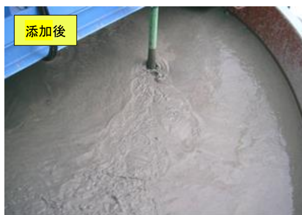
気泡シールド工法の掘削土流体輸送での FT-01 消泡効果(調整槽)
