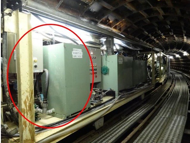
気泡土用の消泡材自動作液ユニット (セグメント内径: φ 2,544mm)
