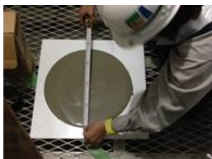
フロー値測定状況 (円筒フローコーン)
