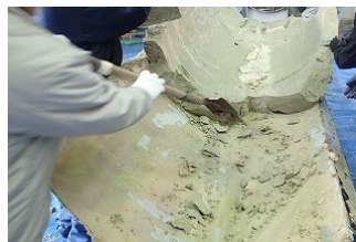
硬化後も人力によって掘削可能な強度
