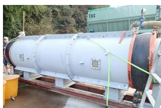
充填性確認用鋼管への充填 (狭小さや管内の充填を再現)
