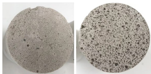
起泡剤種類の違いによる気泡径の差 (空気量 68%)
