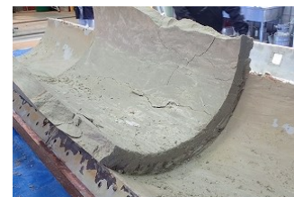
底部の充填状況 (分離することなく底部まで充填)
