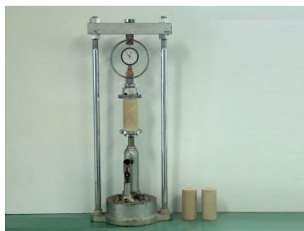
一軸圧縮試験機による圧縮強度
