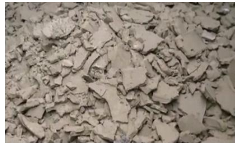
フィルタープレス開栓後の脱水ケーキ
