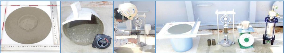
裏込め注入材試験 (フロー値、ゲルタイム、一軸圧縮強度)
