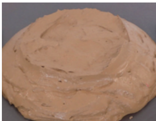
掘削残土 TAC ギャザー添加前
